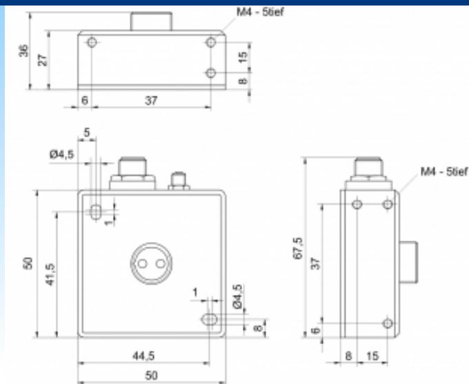
Name **SPECTRO-3-FIO-SLA**Artikelnummer **08386009410**Schaltart  analogSignalart  analog Strom/SpannungLichart  WeißlichtAnschluss  Stecker 8-polig
