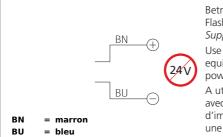
Betrieb ausschließlich mit Flash-Controller an einem Supply Class 2 - Netzteil!
