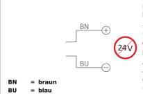
Betrieb ausschließlich mit Flash-Controller an einem Supply Class 2 - Netzteil!
