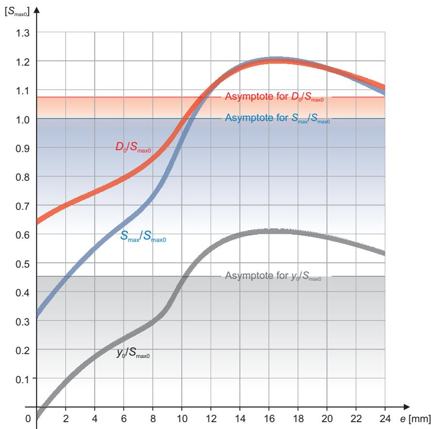
Diese synthetischen Kurven sind zur Entscheidung enthalten, was die Dicke des Abstandshalters für den S/L-Abstand oder die Breite der S/L-Bereich gewünscht.
