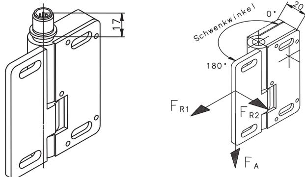
Darstellung mit fixierter Welle und abgescherter Abrisschraube.
